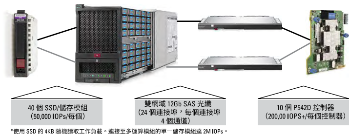
圖 7-2：HPE Synergy 儲存模組非封鎖光纖架構。
